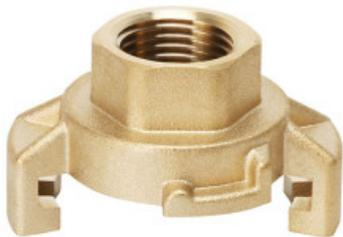
Le raccord express en laiton avec filetage F 15/21 est conçu pour l'arrosage ou le transfert d'eau. Il permet de connecter un tuyau d'arrosage (avec un raccord à visser) ou une pompe d'arrosage. Le raccord s'emboîte facilement par rotation dans un autre raccord express, avec un joint d'étanchéité inclus.
