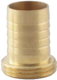
Raccord cannelé en laiton 1 pièce 19 mm avec filetage M 20/27. Il permet de raccorder un tuyau d'arrosage de Ø 19 mm en vissant directement la partie filetée sur un robinet extérieur et en fixant le tuyau sur la partie cannelée.
