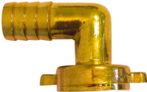
Raccord coudé cannelé en laiton avec filetage femelle 20/27 et écrou tournant. Il permet d'installer un tuyau d'arrosage de Ø 15 mm sur un filetage mâle 20/27 comme un robinet extérieur. L'écrou tournant facilite le vissage, avec un joint d'étanchéité inclus.
