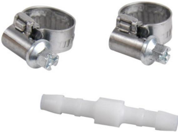
Manchon plastique Ø 4 mm conçu spécialement pour les tuyaux cristal. Il permet de connecter deux tuyaux de Ø 4 mm. Fabriqué en Europe, en POM (copolymère acétal) de haute qualité, il supporte une pression maximale de 10 bars à 20°C. Il convient pour les liquides tels que l'eau, les hydrocarbures et les liquides alimentaires, mais ne convient pas pour les acides ou liquides chlorés. Deux colliers de serrage sont inclus.
