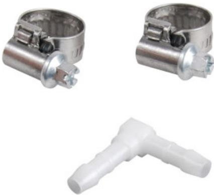
Le coude plastique Ø 4 mm conçu spécialement pour tuyau cristal permet de connecter deux tuyaux de Ø 4 mm. Fabriqué en Europe, en POM (copolymère acétal) de haute qualité, il supporte une pression maximale de 10 bars à 20°C. Il convient pour les liquides tels que l'eau, les hydrocarbures et les liquides alimentaires, mais ne convient pas pour les acides ou liquides chlorés. Deux colliers de serrage sont inclus.
