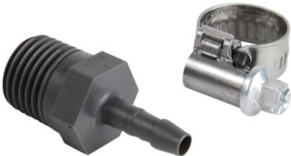
Le raccord plastique Ø 4 mm - M 8/13 spécial tuyau cristal permet de connecter un tuyau de Ø 4 mm à un raccord F 8/13 à visser. Il est fabriqué en POM de haute qualité en Europe. Il supporte une pression de 10 bars à 20°C. Ce raccord convient pour l'eau, les hydrocarbures et les liquides alimentaires. Il n'est pas adapté aux acides ou liquides chlorés. Un collier de serrage est inclus.
