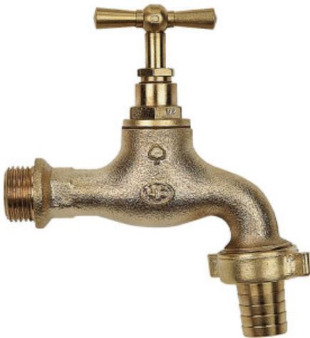
Robinet de puisage en laiton brossé M 15/21. Il est fabriqué en laiton pour une meilleure robustesse et longévité. Il est livré avec un nez de robinet F 20/27 pour un tuyau de diamètre 15 mm.
