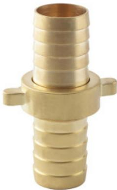
Raccord cannelé en laiton 3 pièces Ø 15 mm avec filetage mâle et femelle 20/27. Il permet de relier deux tuyaux d'arrosage de Ø 15 mm, en les emboîtant sur les extrémités cannelées et en les vissant à l'aide de l'écrou pour garantir l'étanchéité, avec un joint d'étanchéité inclus.
