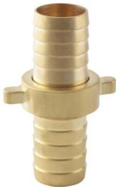
Raccord cannelé en laiton 3 pièces Ø 25 mm avec filetage mâle et femelle 26/34. Il permet de relier deux tuyaux d'arrosage de Ø 25 mm, en les emboîtant sur les extrémités cannelées et en les vissant à l'aide de l'écrou pour garantir l'étanchéité, avec un joint d'étanchéité inclus.
