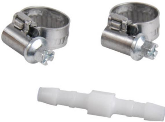
Manchon plastique Ø 12 mm conçu spécialement pour les tuyaux cristal. Il permet de connecter deux tuyaux de Ø 12 mm. Fabriqué en Europe, en POM (copolymère acétal) de haute qualité, il supporte une pression maximale de 10 bars à 20°C. Il convient pour les liquides tels que l'eau, les hydrocarbures et les liquides alimentaires, mais ne convient pas pour les acides ou liquides chlorés. Deux colliers de serrage sont inclus.
