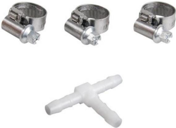
Le Té plastique Ø 12 mm conçu spécialement pour tuyau cristal. Il permet de connecter trois tuyaux de Ø 12 mm. Fabriqué en Europe, en POM (copolymère acétal) de haute qualité, il supporte une pression maximale de 10 bars à 20°C. Il convient pour les liquides tels que l'eau, les hydrocarbures et les liquides alimentaires, mais ne convient pas pour les acides ou liquides chlorés. Trois colliers de serrage sont inclus.
