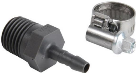
Le raccord plastique Ø 10 mm - M 12/17 spécial tuyau cristal permet de connecter un tuyau de Ø 10 mm à un raccord F 12/17 à visser. Il est fabriqué en POM de haute qualité en Europe. Il supporte une pression de 10 bars à 20°C. Ce raccord convient pour l'eau, les hydrocarbures et les liquides alimentaires. Il n'est pas adapté aux acides ou liquides chlorés. Un collier de serrage est inclus.
