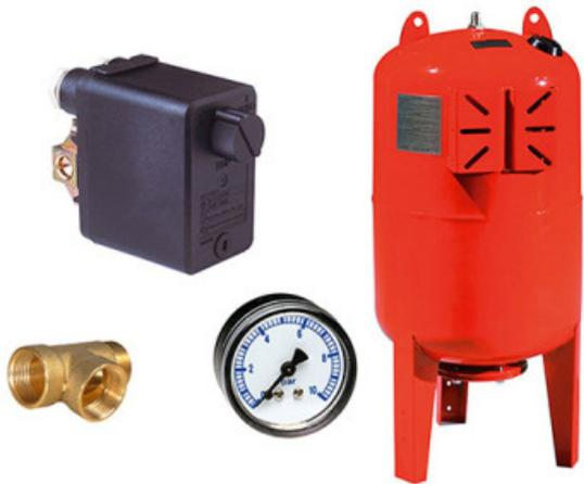
Le kit complet inclus : - 1 raccord 3 voies laiton - 1 réservoir à vessie de 100 litres position verticale (MM 26/34) gonflage à 1,8 bars - 1 manomètre 0/10 bars - 1 contacteur manométrique (pressostat) bipolaire / tripolaire à insérer sur la ligne entre la pompe et le réseau 230 V (réglage usine 2 - 3,5 bars)
