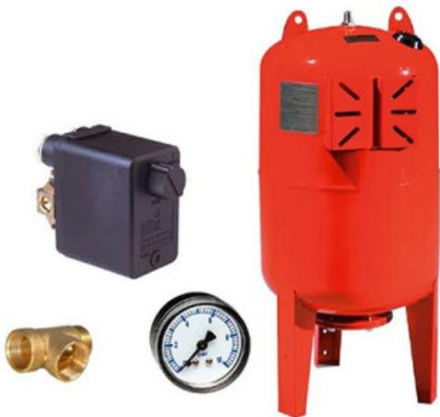
Le kit complet inclus : - 1 raccord 3 voies laiton - 1 réservoir à vessie de 200 litres position verticale (M 40/49 - M 26/34) gonflage à 1,8 bars - 1 manomètre 0/10 bars - 1 contacteur manométrique (pressostat) bipolaire / tripolaire à insérer sur la ligne entre la pompe et le réseau 230 V (réglage usine 2 - 3,5 bars)
