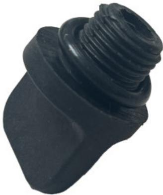
Bouchon 1/4" fourni avec un joint torique, adapté aux pompes SPR et SPIVARIO POOL. Diamètre intérieur : 8 mm – diamètre extérieur : 13 mm. Compatible avec les modèles 002961, 002962, 002963 et 002964.
