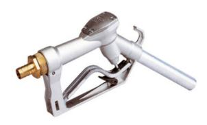
Ce pistolet manuel pour carburants s'adapte à tout système de transvasement. Son corps en aluminium est protégé par une coque plastique anti-choc offrant une bonne prise en main, même à basse température. Le raccord laiton cannelé Ø20 mm assure une connexion solide et étanche. Débit maximal : 60 L/min. Conçu pour la pompe Spid'O TR25 (réf. 002645).
