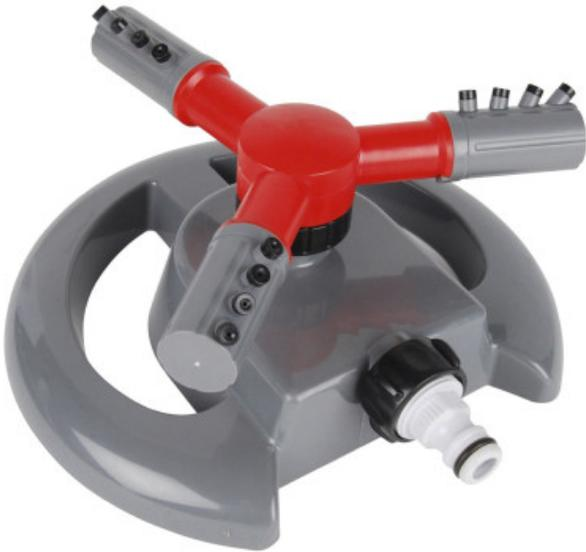
Cet arroseur rotatif sur socle assure un arrosage uniforme du jardin sans formation de flaques. Ses buses orientables à 45° et sa rotation à 360° permettent une couverture jusqu'à 100 m<sup>2</sup>. En ABS résistant aux chocs, il se connecte rapidement grâce à un raccord automatique standard. Idéal pour les pelouses et massifs.
